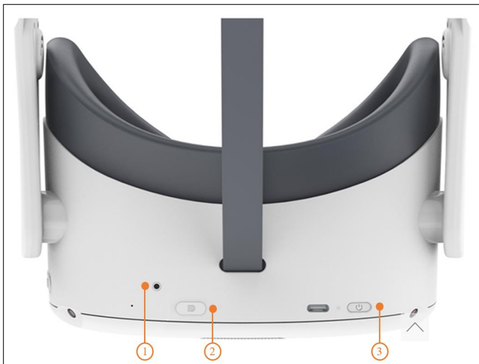
Рисунок 19 – Функциональные элементы шлема
