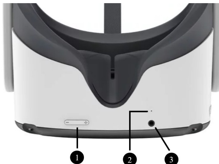
Рисунок 34 – Схема основных функциональных элементов шлема Pico «Neo 3 Pro»
