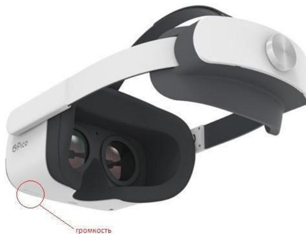
Рисунок 23 – Обозначение громкости на гарнитуре
