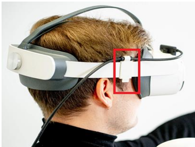
Рисунок 36 — Крепление для фиксации кабеля на шлеме
