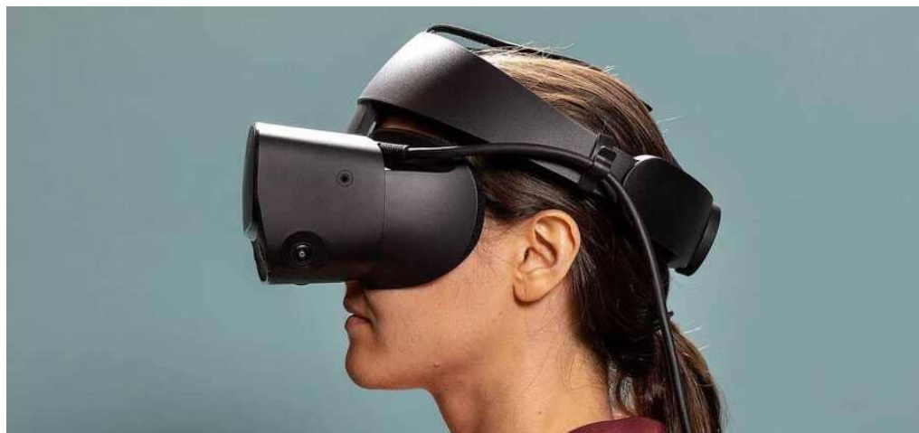
Рисунок 26 – Пример правильного положения шлема Oculus на голове
