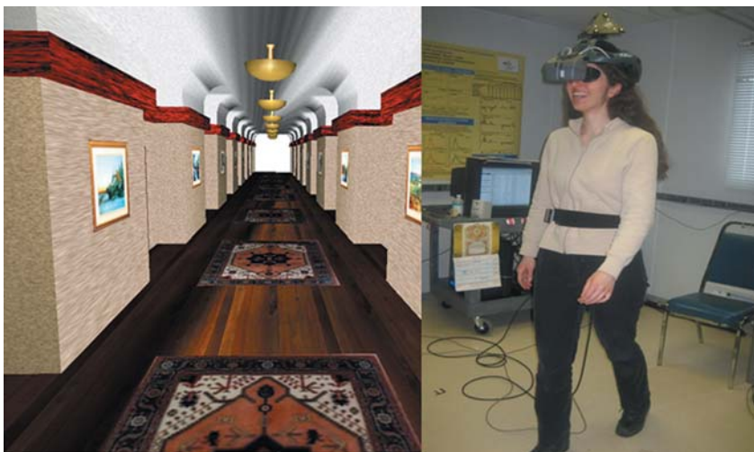
Рис. 7.3. Шлем с вмонтированными дисплеями для проекции виртуального коридора. Модель ProView™ XL35, выпускаемая компанией Rockwell Collins ( http://www.rockwellcollins.com )
