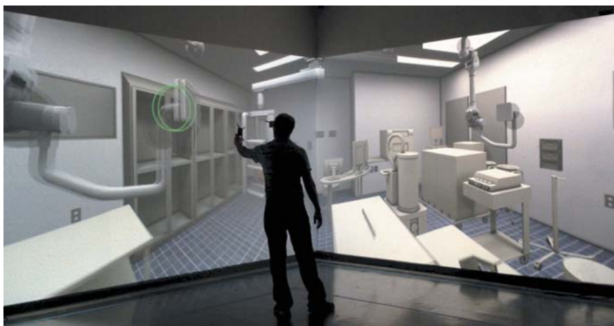
Рис. 7.2. Комната с проецируемыми на стены и пол изображениями виртуального пространства CAVE. Разработана в Реабилитационном институте университета Иллинойс, Чикаго
